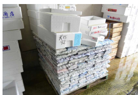
これが発泡スチロールを溶かして作ったインゴット
